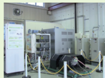
モータ試験装置 (200kW 級, 30,000rpm)
